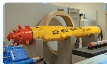
管路を掘削するための機械
