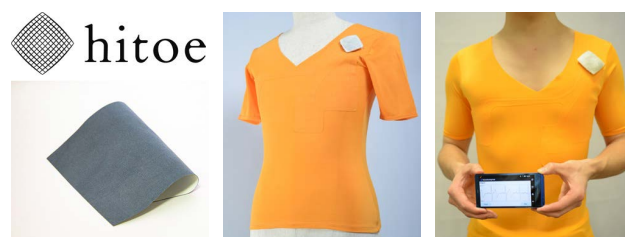
hitoe®を使用した生体情報計測用ウェア(中)、と心拍数・心電波形計測イメージ(右)
