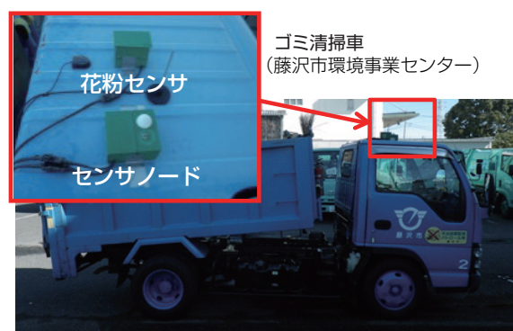
ゴミ清掃車へのセンサ設置例
