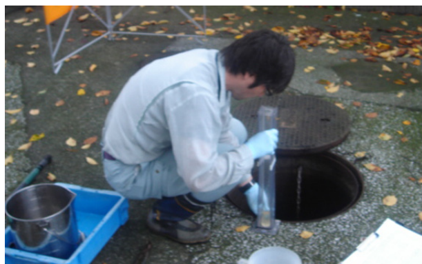
排水水質調査の様子（武蔵野）
