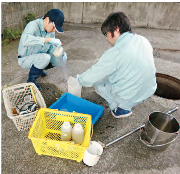
排水水質調査の様子(武蔵野研究開発センタ)
