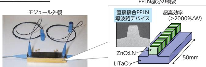
図1 PPLNとPPLN導波路デバイスの概要
