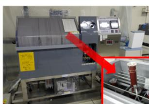
腐食促進試験装置と試験の流れ
