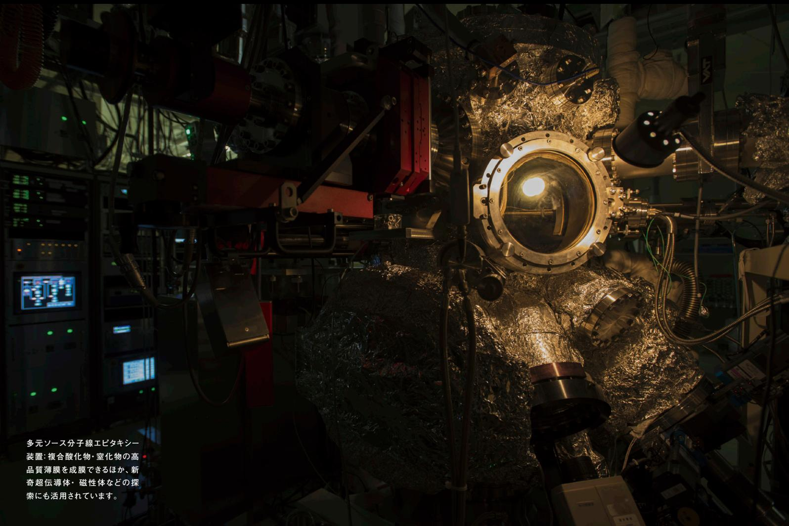
多元ソース分子線エビタキシー装置: 複合酸化物・窒化物の高品質薄膜を成膜できるほか、新奇超伝導体・磁性体などの探索にも活用されています。
