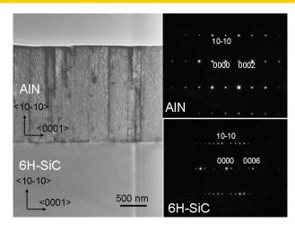
m面AINの断面透過電子顕微鏡像と電子線回折パターン
