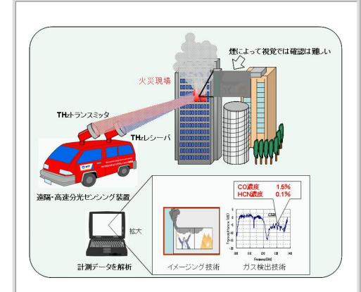
遠隔・高速分光センシング装置を小型にすることで火災 現場で迅速かつ安全な人命救助が可能となる。
