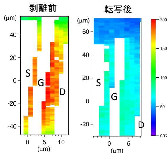
出力0.7 Wでの剥離前および転写後のHEMTの温度分布。剥離前200°C以上に上昇したが、転写後では70°C程度にとどまった。
