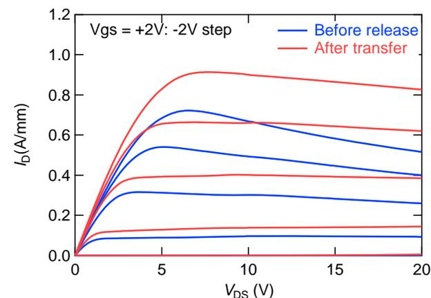
HEMTの転写前後の電流電圧特性。放熱性の向上によりドレイン電流が大幅に増加。負性抵抗も大きく抑制された。
