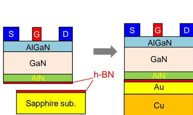
h-BN剥離・転写の模式図。h-BN上に作製したHEMTを剥離した後、銅板へ転写。
