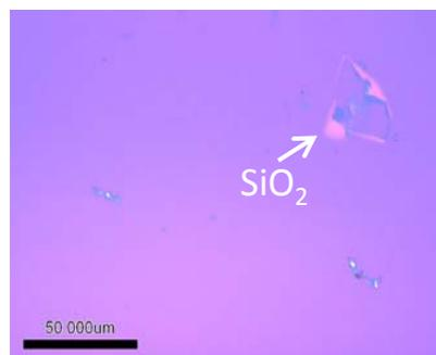
$\text{SiO}_2$ 基板の上に転写した $\text{MoS}_2$ 薄膜
