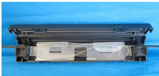
図3 全心接続用クロージャ（AOC-Dクロージャ）
