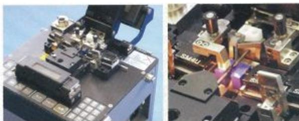
図 個別軸調心ファイバ融着接続装置
