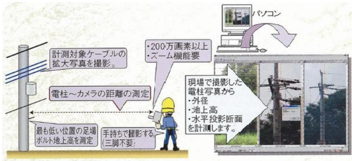
図 電柱計測ツール
