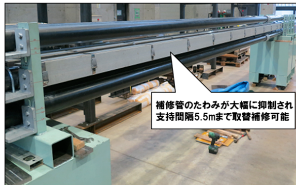
図 S T - L O N G 管の技術ポイントと外観
